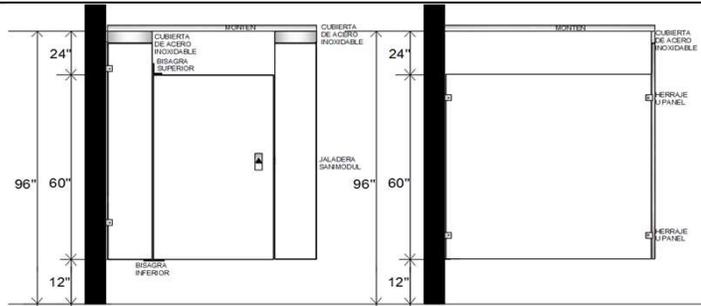
**DETALLE DE SISTEMA DE FIJACION DE PILAISTRA A MONTEN**
